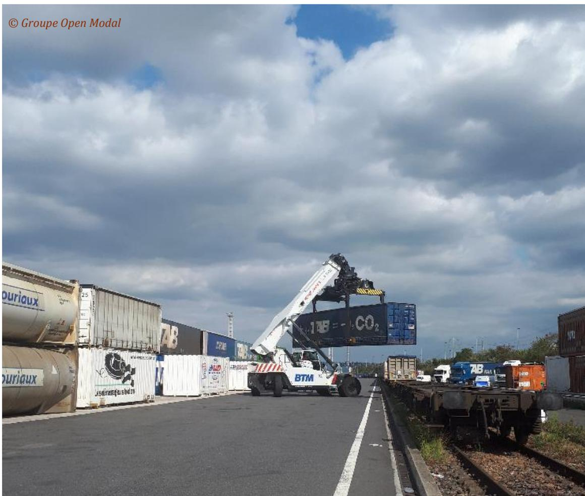
Valenton – RS : chargement d'une caisse mobile par un reach stacker sur le terminal de Valenton.
